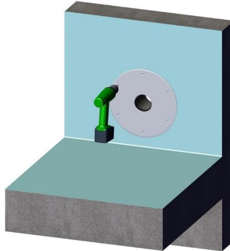
**Schritt 2** Die Wärmedämmung und die Dachabdichtungsbahn fachgerecht gemäß Herstellerangaben aufbringen. Den Ausschnitt für den b/s/t Wasserspeier entsprechend des Durchmessers ausschneiden.
