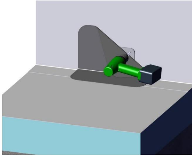
**Schritt 5** Die Anschlussmanschette des b/s/t Wasserspeiers mit der Dachabdichtungsbahn fachgerecht verschweißen.
