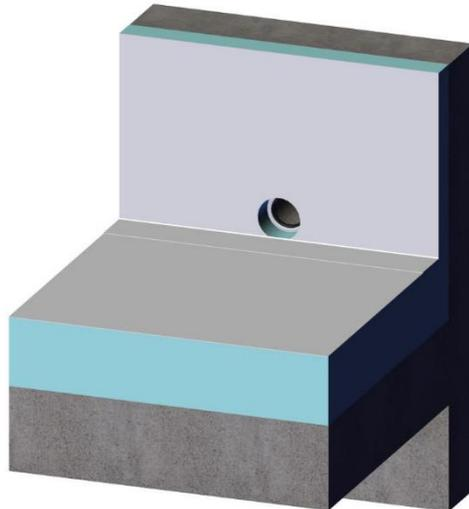
**Schritt 3** Um eine sichere Verbindung und Dichtigkeit zu gewährleisten, muss der b/s/t Wasserspeier durch den Dichtring des b/s/t ALIT Grundelements geschoben werden. Vor dem Einsetzen des b/s/t Wasserspeiers die Dichtung im b/s/t ALIT Grundelement und den b/s/t Wasserspeier mit Gleitmittel versehen. Entstehende Hohlräume fachgerecht ausfüllen.
