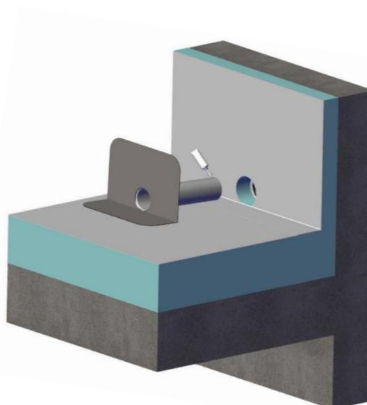
**Schritt 4** Den b/s/t Wasserspeier durch das b/s/t ALIT Grundelement schieben und die Grundplatte fachgerecht befestigen.
